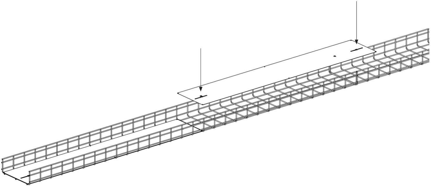
Repita el paso 1, ensamblando la segunda tapa inferior de la bandeja con la tapa previamente instalada.
