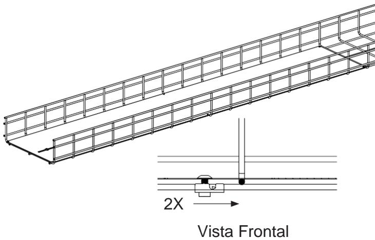
Deslice los 2 clips en los alambres transversales del enrutamiento.
