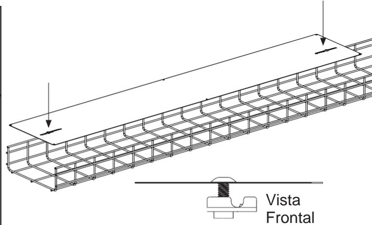
Instale sin apretar 2 clips en las ranuras de la tapa inferior de la bandeja y colóquelos en el enrutamiento.
