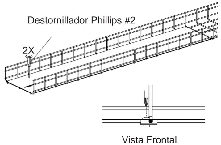
Apriete los tornillos a 75 lbs-IN (8,5 N-m) para garantizar una unión eficaz.
