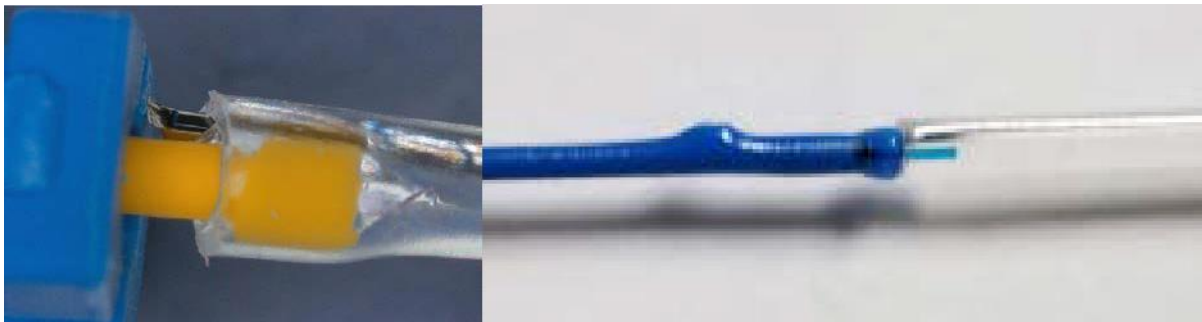
Figura 6: Ejemplos de ajustes de calor incorrectos: contracción excesiva del tubo retráctil que hace que la varilla de refuerzo sobresalga y pueda otros componentes (a la izquierda); ampollas y carbonización del búfer (a la derecha).
