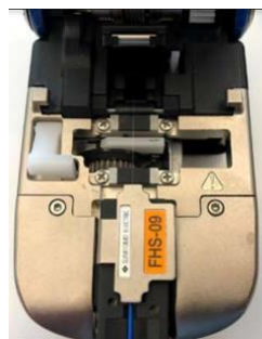
Figura 8: Fibra para uso en campo pelada y limpia en el soporte 900µm, colocada en la cuchilla.
