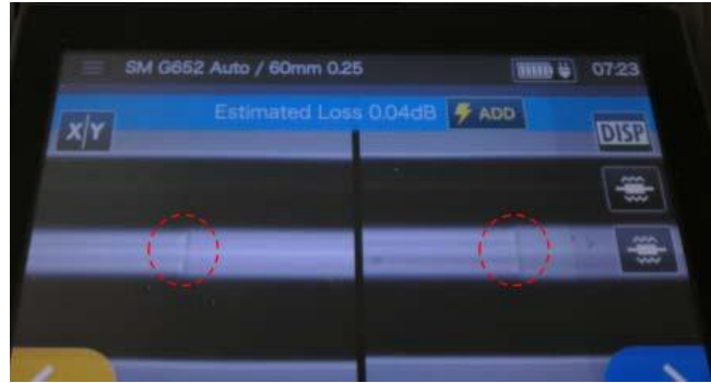
Figura 5: Fibra monomodo G.652 empalmada con vidrio G.657.A2/B2. Tenga en cuenta la diferencia aparente en los núcleos y el evento de empalme definido.
