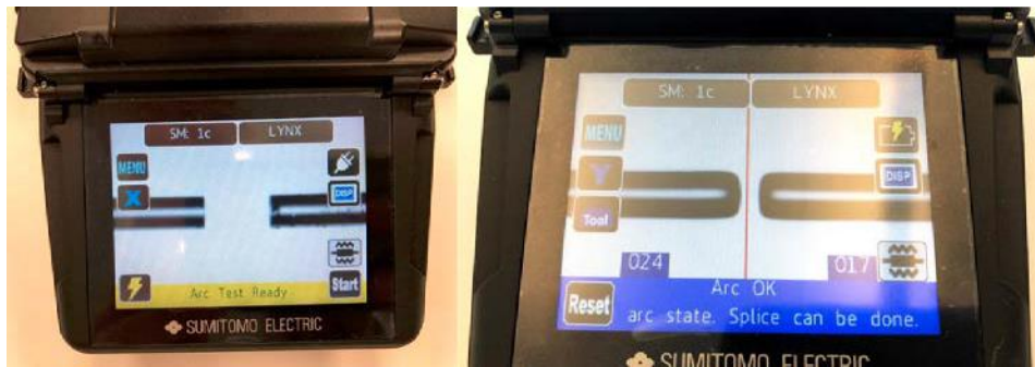
Figura 9: Prueba de arco antes (a la izquierda) y después (a la derecha).
