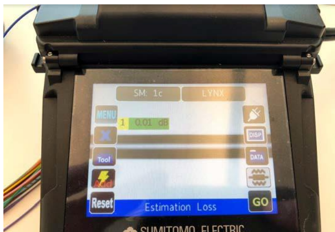
Figura 7: La máquina fusionadora estima que la pérdida de este empalme en particular es de 0.01dB IL, que se incluye en la pérdida general del conector.
