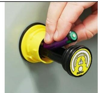
11. Setzen Sie die Batterie ein. Weitere Informationen finden Sie im Abschnitt „Batteriewechsel“ in dieser Bedienungsanleitung.
