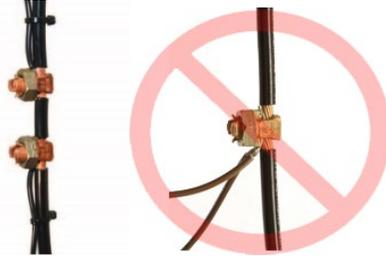
7. Schließen Sie die Sensor- und Erdungsleitungen an. Befestigen Sie die Sensorleitungen an den Leitern und isolieren Sie die Anschlüsse.
