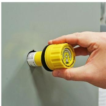
1. Setzen Sie das Anzeigemodul in die 30-mm-Aussparung ein und richten Sie die Drehsicherung aus. Stellen Sie sicher, dass sich die Gummischeibe an der Außenseite des Gehäuses befindet.
