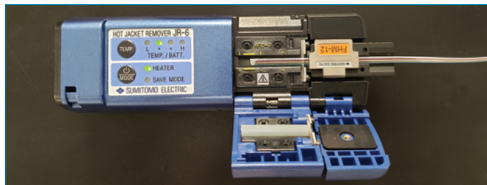
Figura 7: Retire el revestimiento de la fibra.
