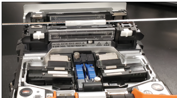
Figura 16: Imagen de cómo se coloca la Fibra Empalmada con el manguito en el horno 1.
