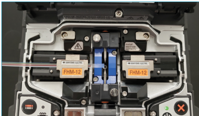
Figura 10: Insertar la(s) fibra(s) desnuda(s) en la fusionadora. Se muestra la abrazadera de funda a la izquierda.
