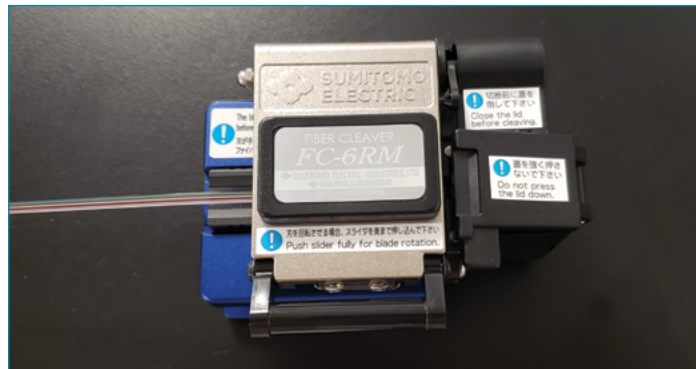
Figura 9: Cortar la(s) fibra(s) desnuda(s).
