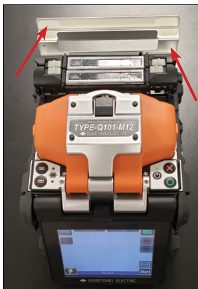
Figura 18: Vista de las bandejas de enfriamiento dobles.
