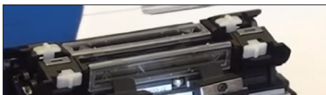
Figura 17: Vista de los cierres del horno.
