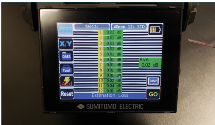
Figura 13: Imagen del proceso de arco completado en la pantalla LCD.
