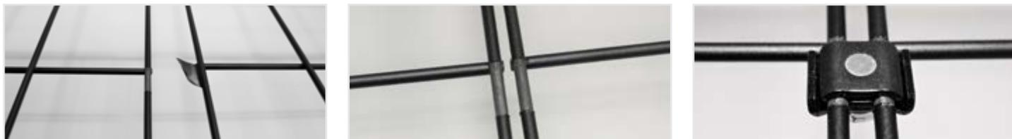
Las uniones atornilladas PWBSPLBL y PWBSPLEZ brindan una unión clasificada por UL cuando se instalan en áreas donde se quitó la pintura. Las bandejas con recubrimiento de polvo incluyen una función de cinta adhesiva que se puede quitar para exponer el metal desnudo en cada extremo. Si la bandeja está cortada, el usuario debe quitar la pintura del metal, si no es una versión electrozincada.
