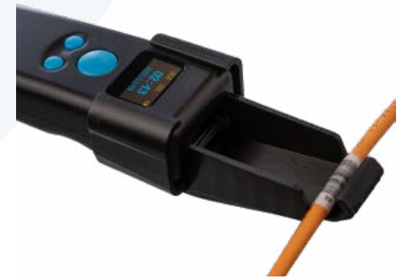
Escáner de código de barras de mano con Bluetooth® y cable pre-etiquetado
