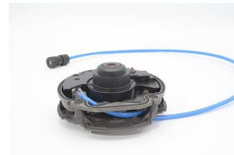
Método B de enrutamiento de cable
