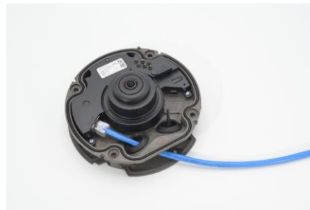
Método A de enrutamiento de cable
