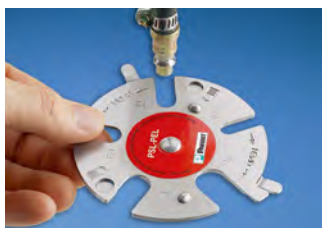
① エアーカプラにフィッティングを取り付ける
